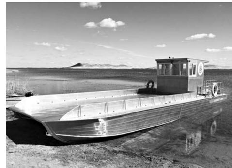
Идеальным местом для верфи стало Федоровское водохранилище. Водный транспорт делают из специального антикоррозийного алюминиевого сплава марки, так называемого морского алюминия. Двигатели и другие детали импортируются из Китая, Европы и Японии. Сейчас на производстве работают 15 человек. Компания производит 60 лодок и катеров в год.
