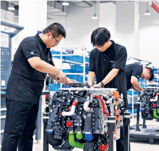
В городе Лушань провинции Цзянси (Юго-Восточный Китай) инженеры собирают системы водородных топливных элементов в производственном цехе компании «Фэнциньнань». Фото: Хань Цзюньсюань
